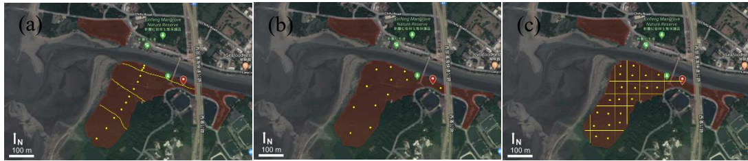
圖1、測站排列策略(a)線性設計(b)隨機設計(c)網格設計
